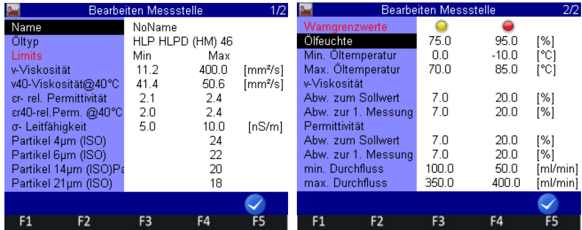
Abbildung 12: Bearbeiten der Parameter für eine Messstelle
