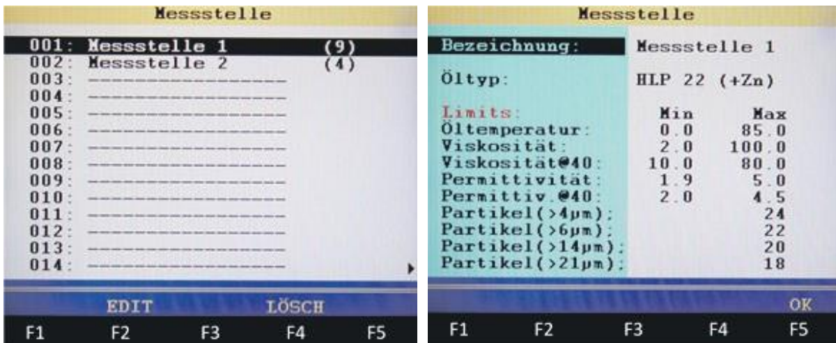
Abbildung 26: links: Messstellenauswahl; rechts: EDIT-Menü der Messstelle
